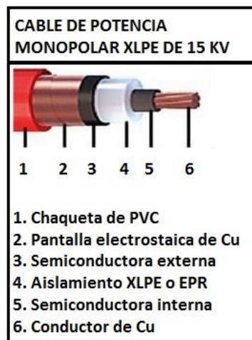
FIGURA 17. Detalle cable monopolar XLPE.
