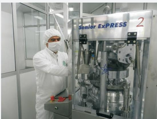
**15. Renovación tecnológica de equipos de producción de medicamentos.** Adquisición de un Molino cónico para el proceso de granulación y mezclado y una Tableteadora Rotativa de 18 estaciones, automatizada. Adquisición de conocimiento de nuevas tecnologías por parte de los estudiantes de Química Farmacéutica. Contribución con la Calidad de los productos elaborados en la Planta de Producción de Medicamentos y aumento de capacidad.
