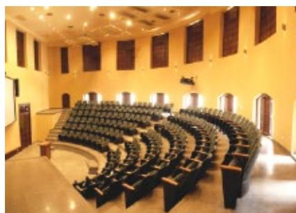
Al auditorio, antiguo anfiteatro, se le instalaron paneles acústicos, rejillas difusoras y ductos de extracción de aire en cielo falso; se le restauró la sillería de cuero y se le modernizó el sistema de iluminación; realizamos la construcción del atril con mando unificado de luces, cámaras y aires; entre otras obras para mejorar sus condiciones.
