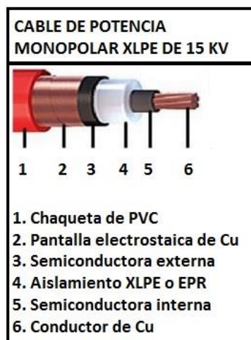
FIGURA . Detalle cable monopolar XLPE.
