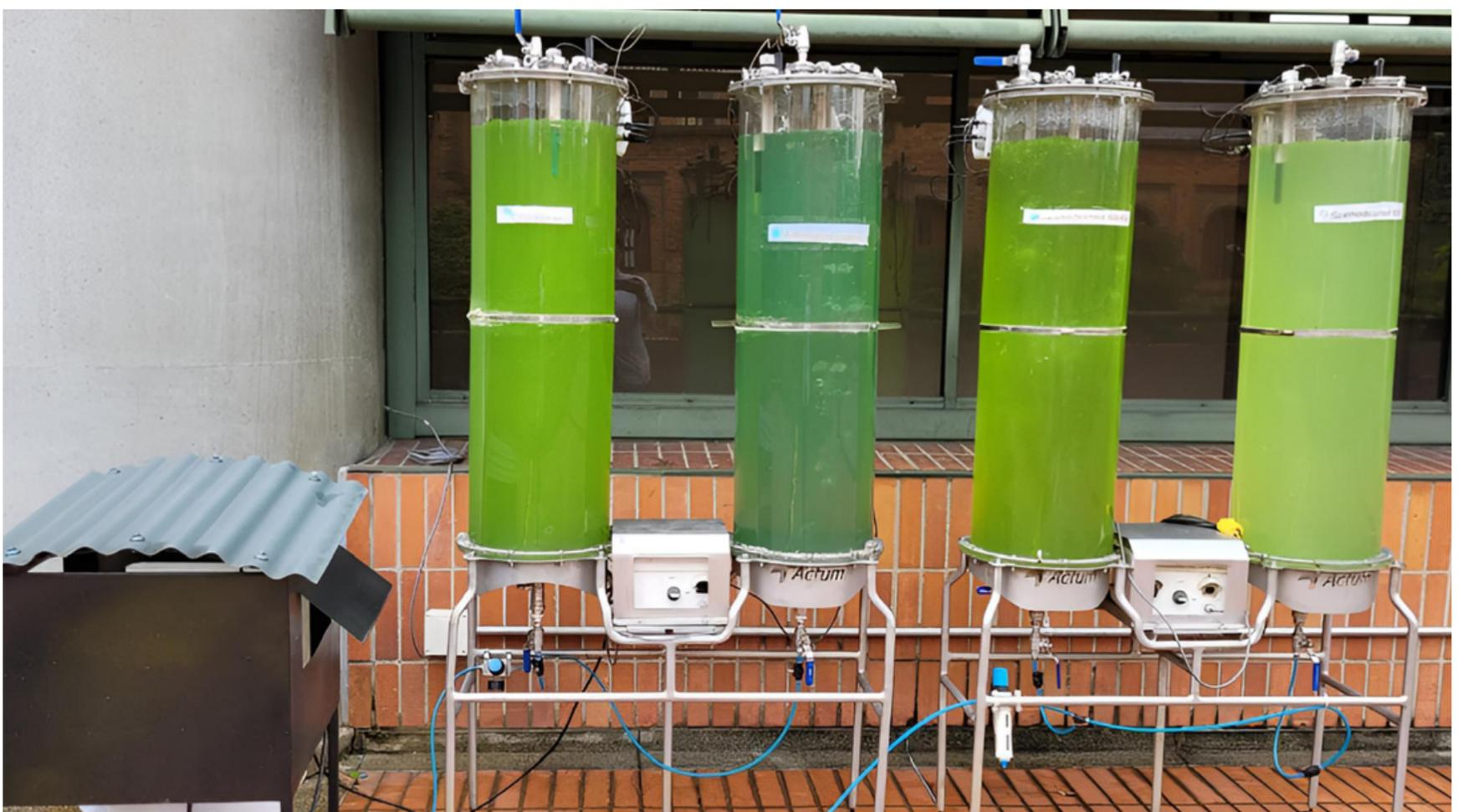
Este sistema de biorreactores de microalgas atrapa cerca de 360 gramos de CO<sub>2</sub> y produce alrededor de 150 gramos de biomasa seca. Foto: cortesía.
